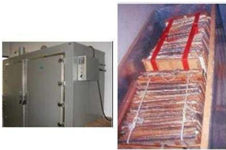
Figura 22 – Exemplos de estufa de secagem de material botânico. A. Estufa industrial. B. estufa de campo.
