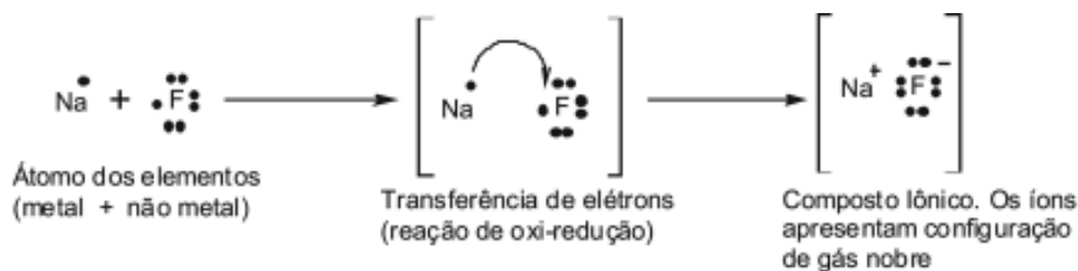
Figura 1: Formação do composto iônico NaF. O elétron da camada de valência do sódio é transferido para o flúor gerando íons \text{Na}^+ e \text{F}^- .
