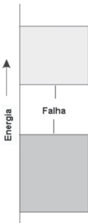
Figura 7: Estrutura de um isolante típico: há uma grande distância de energia entre as bandas cheias e vazias (Fonte: bibliografia 2).
