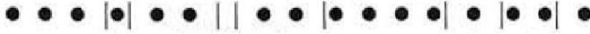
Figura 9.1: Uma possível arrumação de n_j = 16 bósons (bolas escuras) em g_j = 9 níveis, os quais estão esquematicamente separados na figura por g_j - 1 divisórias (linhas verticais). (Figura adaptada da ref. [1].)
