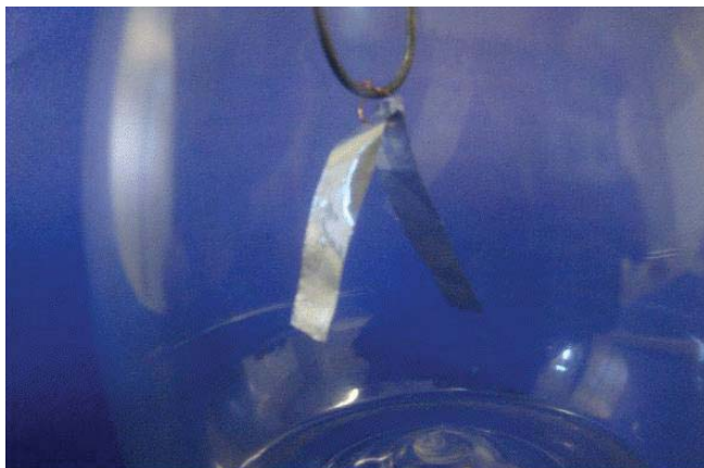
Foto retirada no momento em que é encostado o canudo eletrizado na esfera
