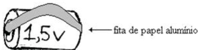
Fita de alumínio ligada nos pólos de uma pilha
