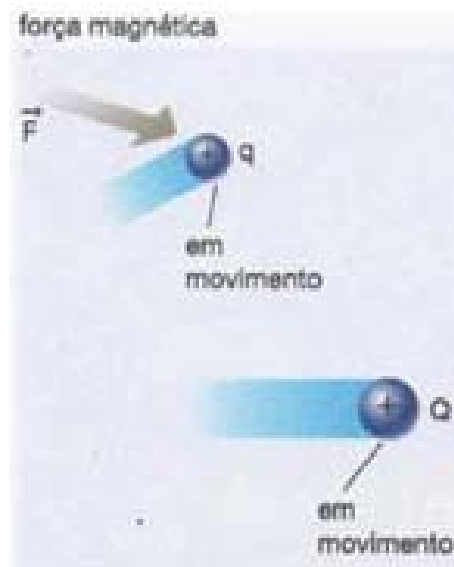
Figura 22-7 – Ilustração esquemática. Quando duas cargas elétricas estão em movimento, manifesta-se entre elas, além da força elétrica, uma força magnética.
