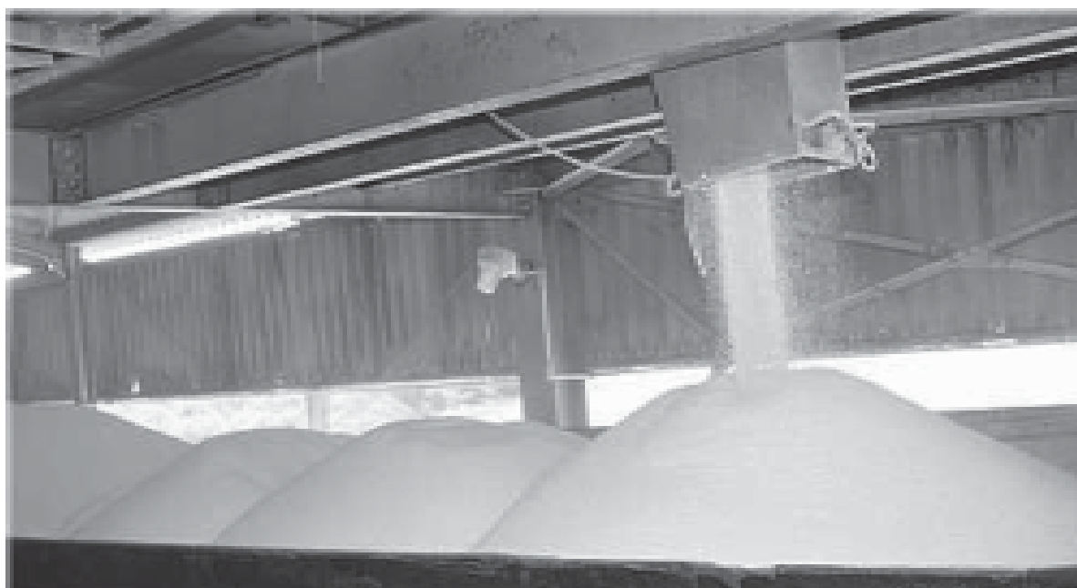
Uréia granulada – Unidade de Granulação instalada em Sergipe, única do país (Fonte: www.revistafator.com.br ).
