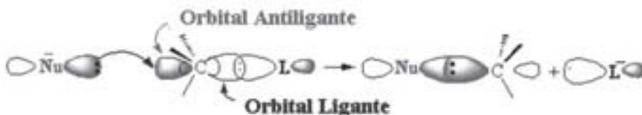
Figura 2: Modelo de orbitais moleculares na inversão da configuração nas reações  $S_N2$ .
