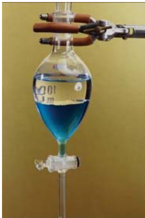
Funil de separação utilizado na separação de líquidos miscíveis e na extração de líquido-líquido. (Fonte: http://www2.fc.unesp.br )
