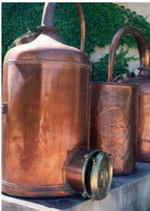
Alambique, equipamento de destilação simples. Foi utilizados desde os tempos remotos, frequentemente relacionado a alquimia. Utilizado na fabricação de aguardente, por exemplo. (Fontes: http://4.bp.blogspot.com )
