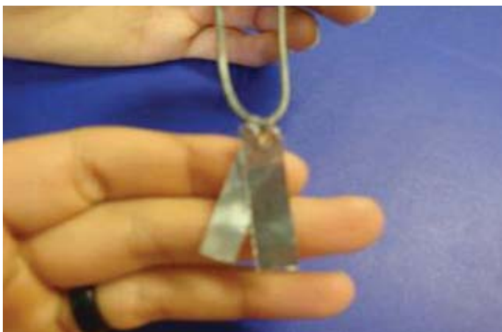
Duas tiras de papel alumínio com 3cm de comprimento cada, presas com 1cm de fio de cobre (número 28), colocadas no gancho.
