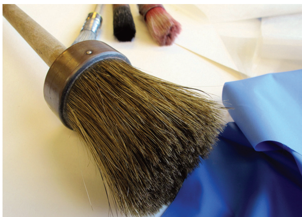
Figura 47 – É importante que a limpeza seja feita a seco, com o auxílio de aspiradores, trinchas, pincéis com cerdas macias, escovas também macias e flanelas de algodão, de acordo com a resistência do material do suporte
