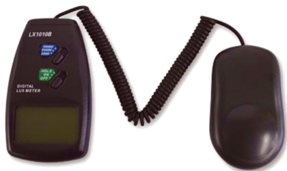
Figura 44 – Exemplo de um luxímetro, aparelho destinado a medir a intensidade da luz
