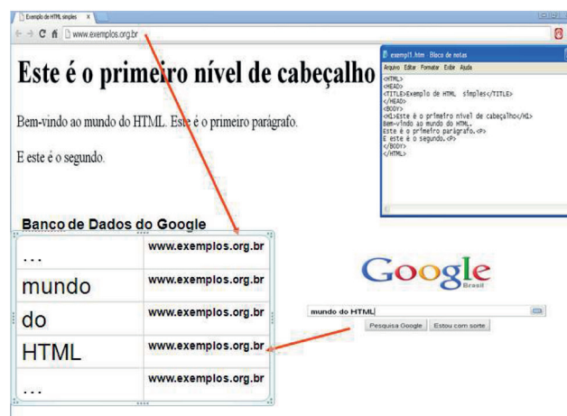
Figura 46 – Processo de indexação de páginas web pelo indexador de um mecanismo de busca
