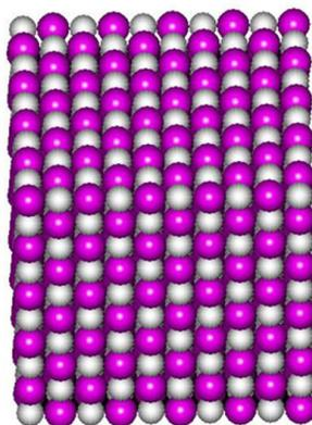
Figura 2: Estrutura cristalina do Cloreto de Sódio (NaCl). Sódio: Rosa; Cloro: Branco.
