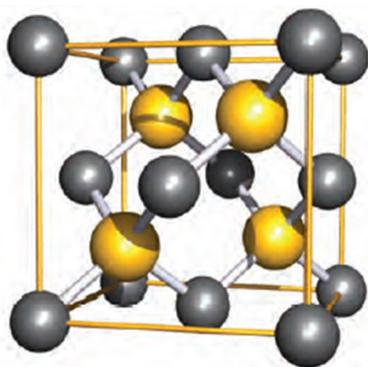
Figura 8: Representação da célula unitária em blenda do ZnS (Zn<sup>2+</sup>: cinza; S<sup>2-</sup>: amarelo).
