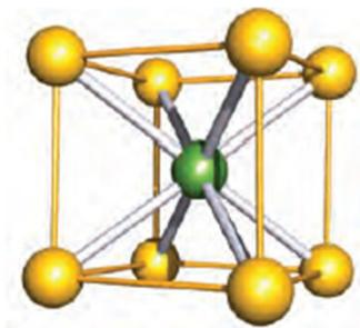
Figura 7: Representação da célula unitária do CsCl (Cs+: verde; Cl-: dourado).
