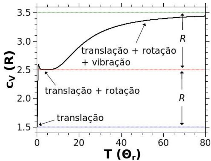
Figura 7.6: Calor específico molar a volume constante de um gás ideal diatômico considerando os movimentos de translação, rotação e vibração das moléculas, para  $\Theta_v = 70\Theta_r$ .
