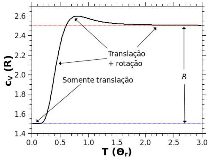
Figura 7.4: Calor específico molar a volume constante de um gás ideal diatômico considerando apenas os movimentos de translação e rotação das moléculas.
