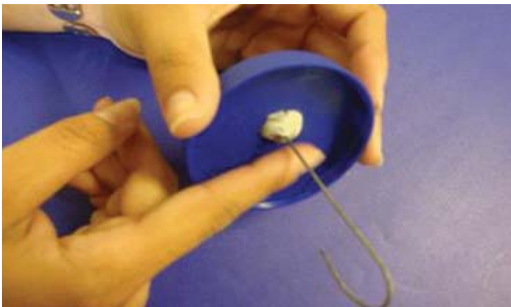
Fixação do arame na tampa com o adesivo epóxi.
