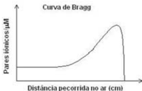
Figura 64. Número de pares iônicos (ionização) formados pela partícula \alpha em função da distância percorrida no ar em centímetros (Conde-García, 1998, p. 307).
