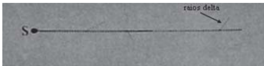
Figura 63. Trajetória retilínea de uma partícula alfa na câmara de bolhas de Wilson. As ramificações observadas ao longo da sua trajetória são elétrons ejetados pela radiação alfa. Estes elétrons são chamados de raios delta (Conde-Garcia, 1998, p.306).
