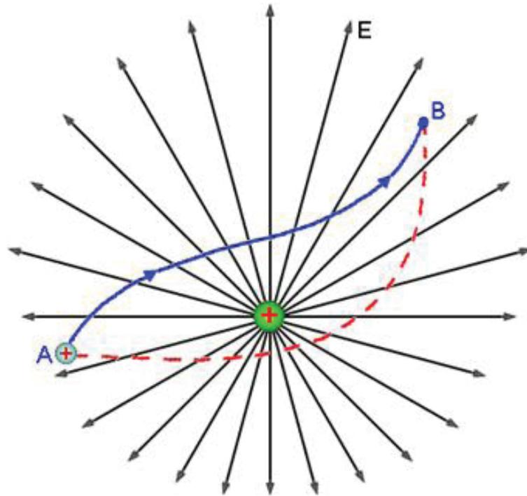
Figura 1 – Movimento de uma partícula na presença de campo elétrico
