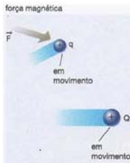
Figura 22-7 – Ilustração esquemática. Quando duas cargas elétricas estão em movimento, manifesta-se entre elas, além da força elétrica, uma força magnética.
