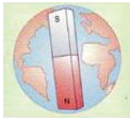
Figura 22-4 – O norte geográfico da Terra é um pólo sul magnético e o sul geográfico é um pólo norte magnético.
