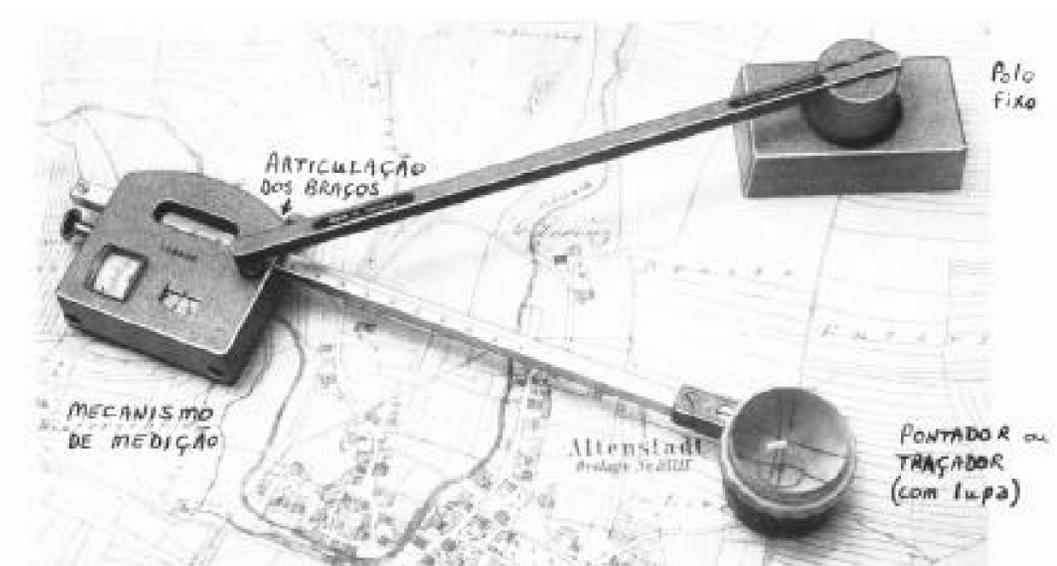
Figura 3. Planímetro mecânico
