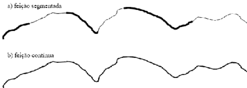
Figura 15. Feição que está segmentada, mas que deve ser contínua.
