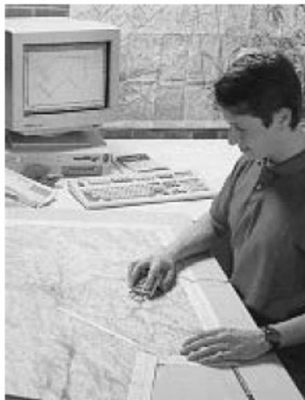
Figura 12. Digitalização de uma carta topográfica com mesa de digitalização.
