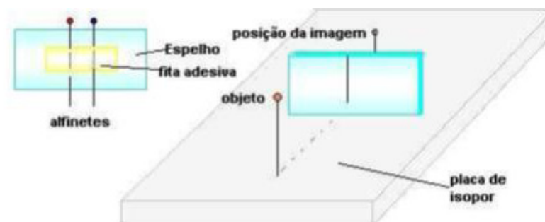
Figura 30 - Montagem para a determinação da posição da imagem. Disponível em: http://portaldoprofessor.mec.gov.br/storage/recursos/14555/formacaoeposicaoaimagemnosespelhosplanos.pdf .
