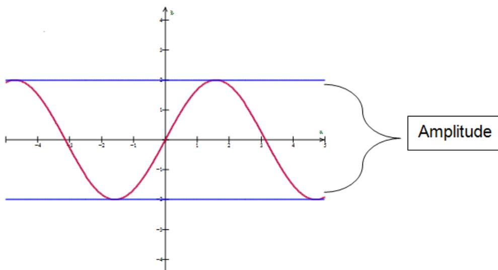
Figura 5 - Amplitude da onda (Winplot).
