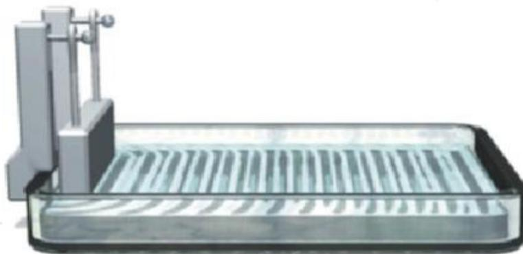
Figura 9 – Tanque de Ondas. Tipler, Física (Editora LTC, 2000).
