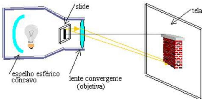
Figura 9 - Esquema simplificado do projetor de slides.
