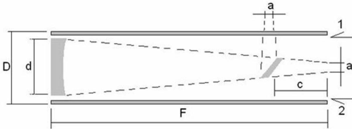
Figura 12 - Esquema de um telescópio refletor
