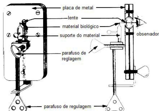
Figura 18 - Microscópio óptico.
