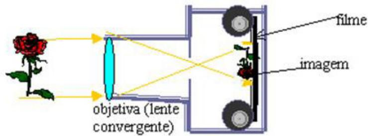
Figura 8 - Formação da imagem em uma máquina fotográfica.
