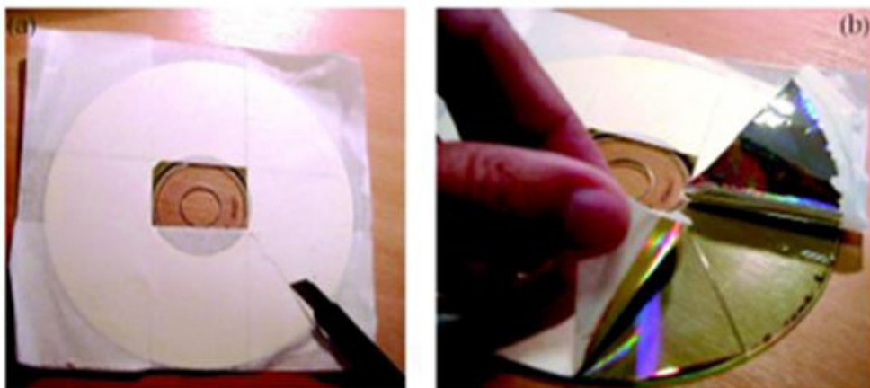
Figura 9 (a) e (b) - Procedimento para a retirada da superfície refletora de um CD.
