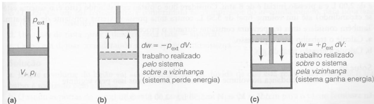
Figura 2. Ilustração de um gás realizando trabalho sobre o sistema ou vizinhança (a) e o trabalho sendo realizado sobre a vizinhança (b) e o trabalho sendo realizado sobre o sistema (c) (Fonte: Ball, 2005).
