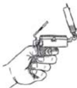
Ao usar a bússola, deve sempre colocá-la o mais na horizontal possível. Se fizer leituras com a bússola inclinada estará cometendo erros. O polegar deve estar corretamente encaixado na respectiva argola, com o indicador dobrado debaixo da bússola, suportando-a numa posição nivelada.
