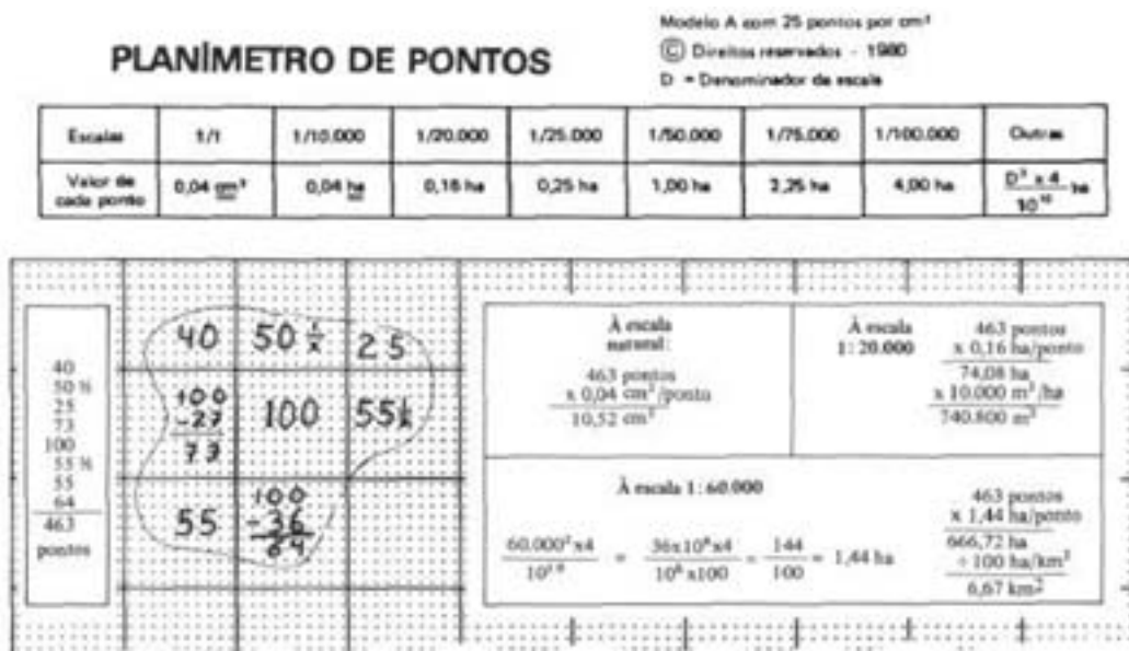
Figura 4. Exemplo de medição de uma área com planímetro de pontos.
