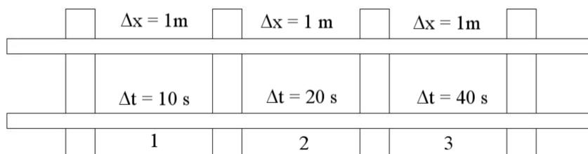
Esta figura mostra uma linha de trem, onde a diferença entre dois dormentes é sempre de um metro, mas que o tempo que o limpa-trilhos (aquela parte pontuda na frente do trem) leva para atravessar esta distância varia! No trecho 1, leva 10 segundos; no trecho 2, leva vinte segundos; e, no 3, ele leva quarenta segundos. Podemos calcular aqui a velocidade média:
