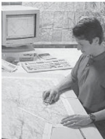
Figura 12. Digitalização de uma carta topográfica com mesa de digitalização.
