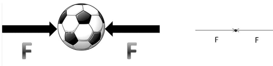
O desenho à esquerda mostra a situação real, onde a bola tem três dimensões e a força é aplicada em um ponto bem definido de sua superfície. Quando tratamos a bola como uma partícula, utilizamos o diagrama à direita. Estes dois casos são equivalentes apenas quando as forças estão sendo aplicadas na mesma direção (note que elas têm sentidos opostos). Considere agora a figura abaixo:
