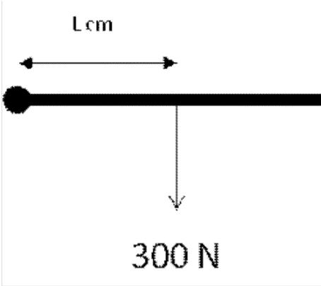
O torque aplicado pelo braço (nesta posição) é de 12 Nm. Para poder levantar este bloco é necessário então um torque maior que este. Calcularemos então qual é a distância L onde deve ser colocado o bloco para obter o mesmo torque:  $\frac{\tau}{F} = L \rightarrow L = \frac{12}{300} = 0,04m = 4cm$ . Este resultado numérico apenas nos confirma aquilo que já sabíamos por experiência.
