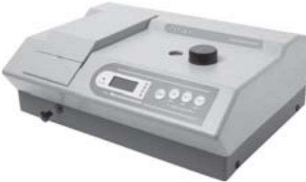
Espectrofotômetro (Fonte: <http://www.labmais.com.br>).
