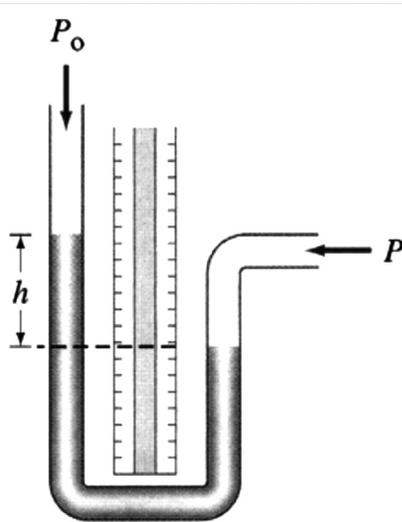
Este manômetro é feito de um tubo em forma de U parcialmente preenchido com um líquido (geralmente mercúrio). A pressão  $P$  que está sendo medida se relaciona diretamente com a diferença em altura  $h$  dos dois níveis do líquido através da relação:
