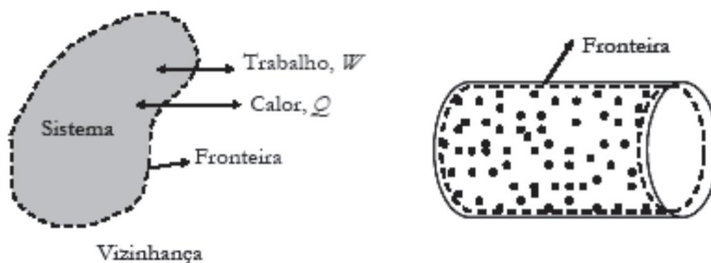
Figura 1. Ilustração de um sistema e vizinhança, veja o caso de um gás contido num cilindro.
