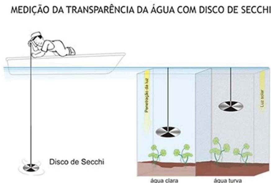
Medição da transparência da água com disco de Secchi.
