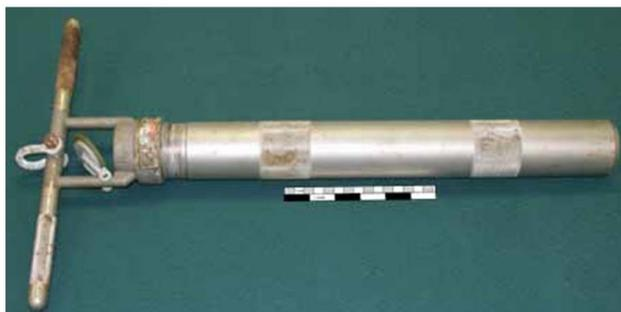
Figura 6. Coletor tipo core. Fonte: EPA (2001).
