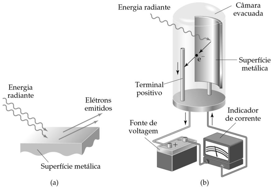
Figura 11 - Efeito fotoelétrico. Quando fótons de energia suficientemente alta colidem com uma superfície metálica, elétrons são emitidos do metal, como em (a). O efeito fotoelétrico é a base da fotocélula mostrada em (b). Os elétrons emitidos são puxados para o terminal positivo. Como resultado, a corrente flui no circuito. As fotocélulas são usadas em medidores de luz para fotografia, bem como em dispositivos eletrônicos (Fonte: Brown, 2005).
