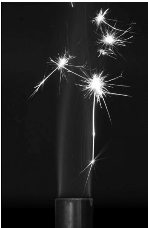
A centelha gerada por um dispositivo de aço golpeado contra um Ferrocérum provendo a energia de ativação para iniciar a combustão de um Bico de Bunsen. (Fonte: [www.ptkipedia.org](http://www.ptkipedia.org)).
