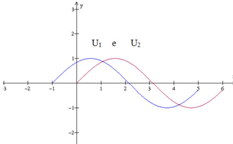
Figura 11 – Ondas com diferença de fase (Winplot).
