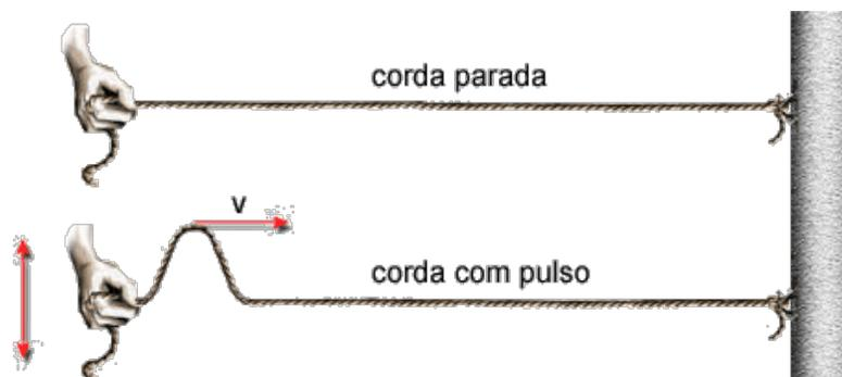
Figura 1 - Ilustração de um pulso propagando-se numa corda.
