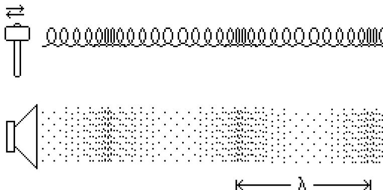
Figura 2 - Ondas longitudinais.
