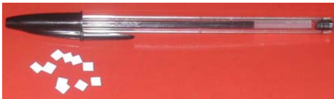
Figura 5.1 Caneta e pedaços de papel para experiência do estudo de carga elétrica.
