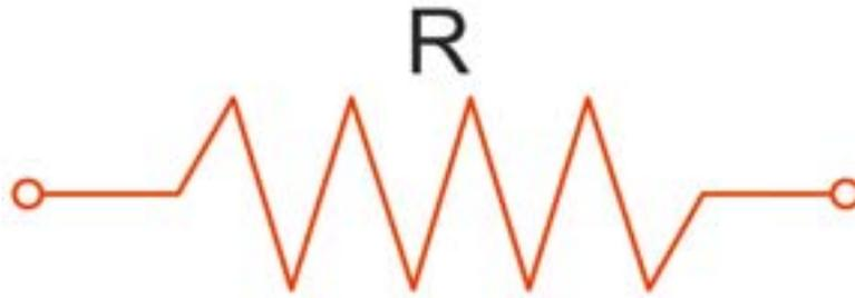
**Figura 8.3** Representação simbólica de um resistor.
