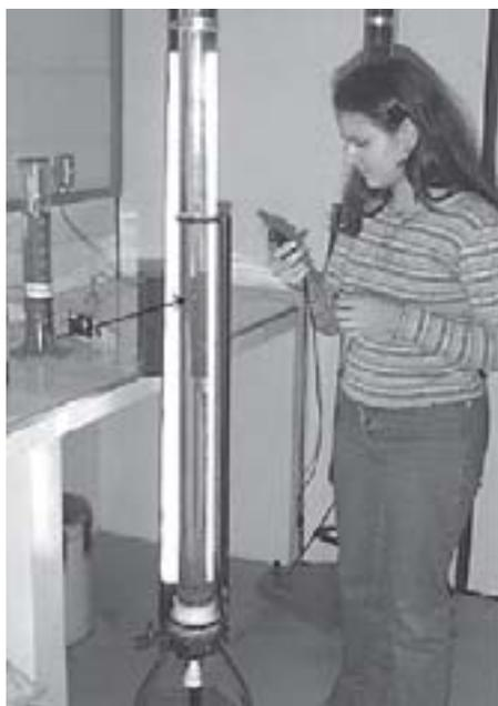
Experimento com *viscosímetro de Stokes*. Para medir a viscosidade de um líquido, uma esfera é lançada no topo do viscosímetro e desce com velocidade terminal (a seta indica a posição instantânea da esfera). A velocidade da esfera é medida e obtém-se a viscosidade. (Fonte: <http://img144.imageshack.us>).
