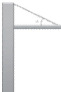
3. Uma escada de 5 metros de comprimento se encontra encostada a um muro a uma altura de 4 metros. Sendo a escada uniforme e tendo uma massa de 12 kg determine até que ponto uma pessoa de 58 kg pode subir antes que a escada comece a escorregar. Assuma que o coeficiente de atrito entre a escada e o chão é 0,4 e que não há atrito entre a escada e o muro.
