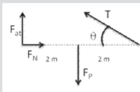
Este belo diagrama de forças mostra que não podemos colocar todos os vetores em um único ponto como no problema anterior. Aqui realmente o torque será fundamental. A primeira condição de equilíbrio exige que a resultante das forças seja igual a zero. Vamos convencionar que existe um eixo  $x$ , horizontal, que vai da esquerda para a direita e um eixo  $y$ , vertical, que vai de baixo para cima. Ainda não diremos onde está a sua origem. Podemos equacionar então a componente vertical:
