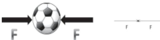
O desenho à esquerda mostra a situação real, onde a bola tem três dimensões e a força é aplicada em um ponto bem definido de sua superfície. Quando tratamos a bola como uma partícula, utilizamos o diagrama à direita. Estes dois casos são equivalentes apenas quando as forças estão sendo aplicadas na mesma direção (note que elas têm sentidos opostos). Considere agora a figura abaixo:
