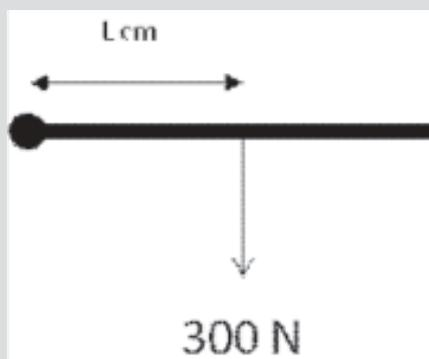
O torque aplicado pelo braço (nesta posição) é de 12 Nm. Para poder levantar este bloco é necessário então um torque maior que este. Calcularemos então qual é a distância L onde deve ser colocado o bloco para obter o mesmo torque:  $\frac{\tau}{F} = L \rightarrow L = \frac{12}{300} = 0,04m = 4cm$ . Este resultado numérico apenas nos confirma aquilo que já sabíamos por experiência.
