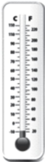
Neste caso, a propriedade física é a variação do volume do líquido. Qualquer variação na temperatura pode ser definida como sendo proporcional à variação em comprimento da coluna líquida. Neste caso é bastante claro que a propriedade física que varia com a temperatura é o volume de um líquido. Qualquer variação na temperatura pode ser definida como proporcional à variação no comprimento da coluna de líquido. O
