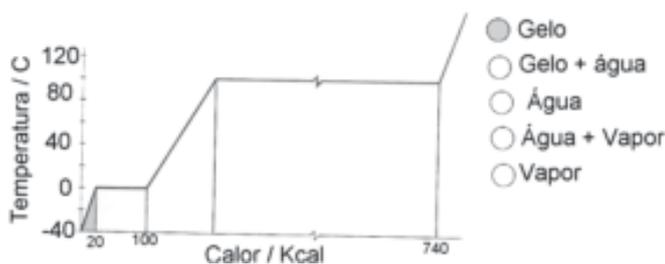
Este gráfico nos mostra como varia a temperatura de cerca de 1,0 kg de água quando um bloco de gelo inicialmente a -40 °C recebe calor externo a uma taxa fixa. Pelo gráfico podemos ver que os primeiros 20 Kcal de energia são utilizados para elevar a temperatura do gelo de -40 °C
