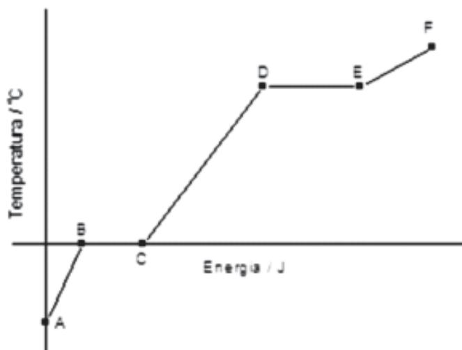
Caracterize o sistema e o processo que ocorre nele em cada um dos segmentos do gráfico. Por que são diferentes os coeficientes angulares dos trechos AB, CD e EF?
