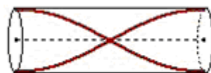
Figura 5.12: Modo fundamental (primeiro harmônico) da onda estacionária numa coluna de ar com extremidades abertas.
