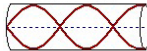
Figura 5.17: Terceiro modo de oscilação da onda estacionária (quinto harmônico) numa coluna de ar com uma extremidade aberta e outra fechada.
