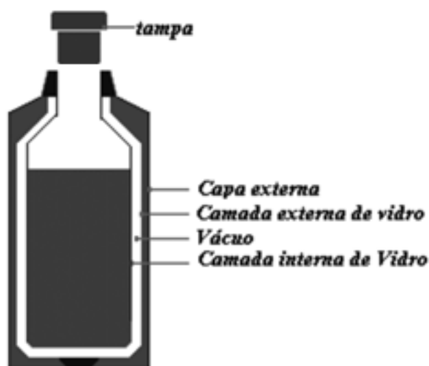
Figura 2: Representação esquemática de um vaso de Dewar.
