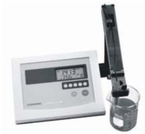
Figura 3: Condutivímetro de bancada (Fonte:<http://www.indiamart.com>).
